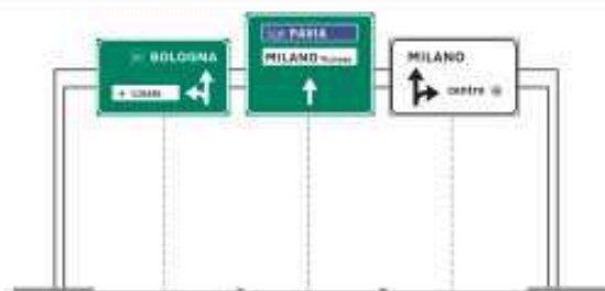
FIGURA 246 SEGNALE DI CORSIA CON FUNZIONE DI PREAVVISO
