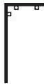
PALO A BANDIERA Ø 60 ZINCATO A CALDO COMPLETO DI 3 FASCETTE E BULLONERIA PER FISSAGGIO TARGA PIANA
